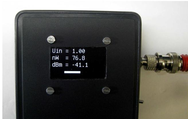
Zum Einsatz kommt, neben dem Arduino-NANO, ein logarithmisches Prüfdetektor Modul mit einem AD8307-Chip. Bei einer Eingangsimpedanz von 50 Ohm arbeitet es im Bereich von 0.1 bis 600 MHz annähernd linear. Das Modul wurde für ca. 8€ über EBAY aus China geordert.
