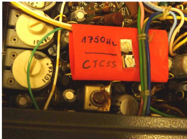
Bild der Einbaulage mit Schrumpfschlauch gesch!utzt.
