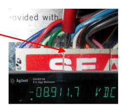
Prüfe Kondensator an der PLC-Leitung (0,01 uF von Anode der Tuning-Dioden gegen Masse.)
