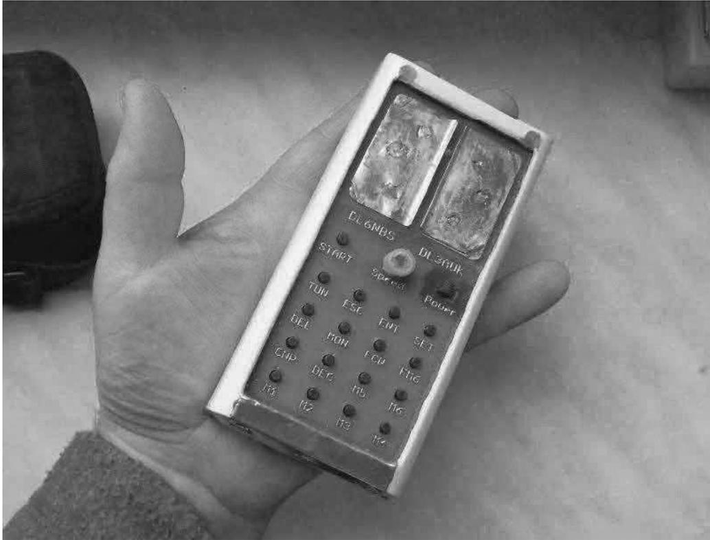
Meine gebrauchsfertige FROG-3 auf der Handfläche. Das Gehäuse stammt von einem alten Zeitschalter, durch die Abrundungen an den Längsseiten liegt es sehr gut unter der Hand. Auf dem Blechstreifen am unteren Rand liegt beim Geben der Handballen auf
