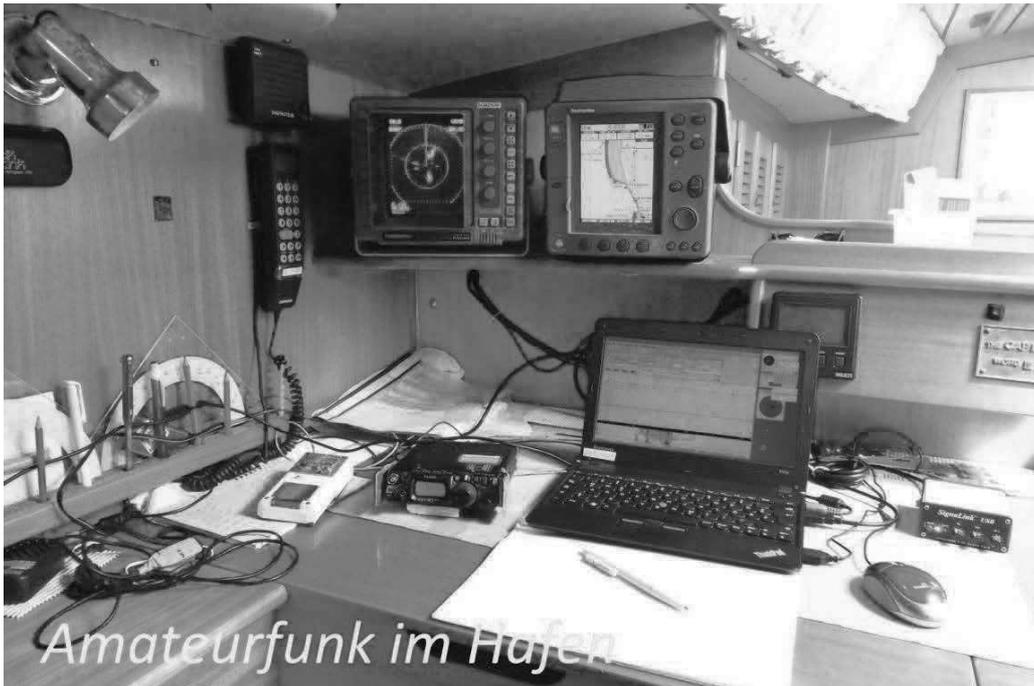
Im Hafen nutze ich den Kartentisch, dann sind auch weitere Betriebsarten möglich, links neben dem FT817 ist wieder meine alte Sensortaste erkennbar. In der oberen Reihe befinden sich Kartenplotter und Sichtgerät der Radaranlage, sie dienen der Schiffsführung. Links an der Wand noch Lautsprecher und Handapparat der Seefunkanlage
