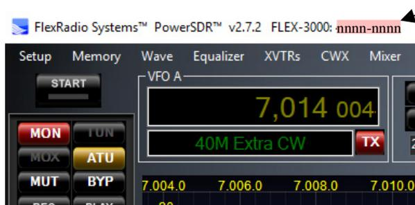
2. Man besorgt sich die Firmware und Beschreibung von KE9NS, Version 2.8.0.52 oder neuer. 60m TX funktioniert nur mit Version 2.8.0., Version 2.7.2 ist ungeeignet! Link zum Download <http://ke9ns.com/flexpage.html>
